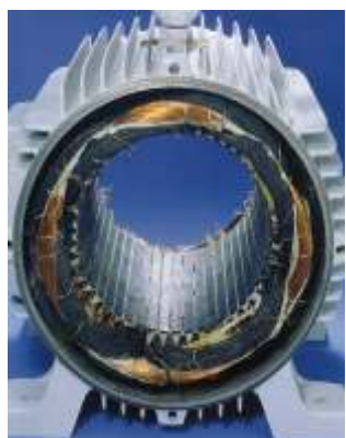
FALTA DE FASE LIGAÇÃO ESTRELA
